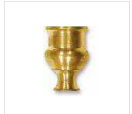
K001 Ø30 x H40 filetto/thread M 10/1 piano sotto/lower flat Ø18 foro interno/internal hole Ø22,5
