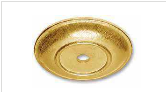
G017 Ø70 x H10 · foro/hole Ø10,5 piano sopra/round flat Ø30 stampato a caldo/hot pressing
